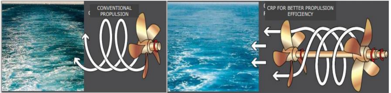
Kuva 17. Vastasuuntiin pyörivien potkureiden toimintaperiaate (15, s. 10.).
