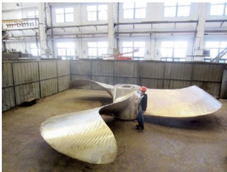
Kuva 13. Kolmilapainen kiinteän nousun potkuri (16, s. 45.).
