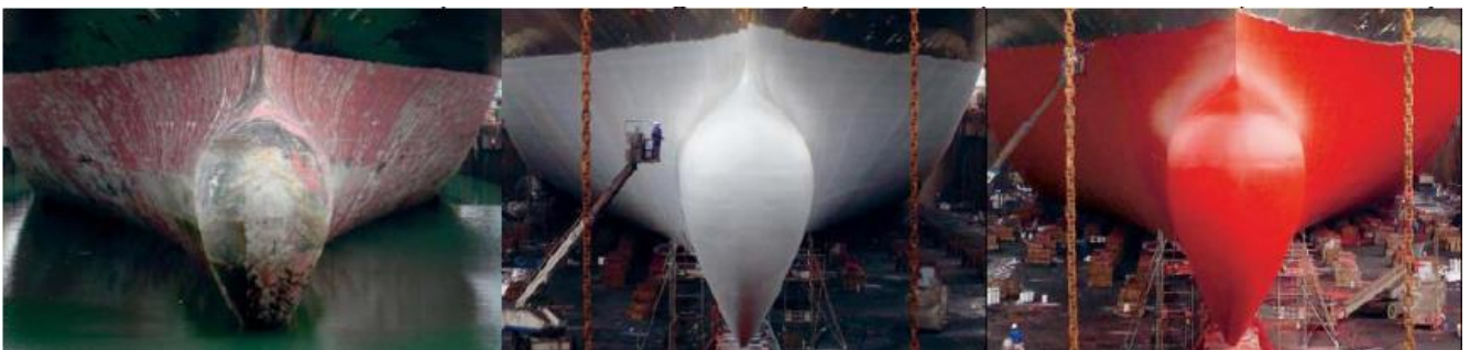
Kuva 12. Laivan maalikerrokset. Anti fouling -pinnoitteet ovat tärkeitä kasvuston kiinnittymisen sekä kitkaominaisuuksien kannalta (15, s. 23.)
