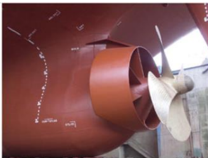
Kuva 16. Becker Marine Systemsin valmistama Mewis -kanava (16, s. 49.).
