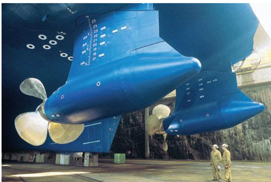
Kuva 15. Sähkömoottorin omaava Azipod-ruoripotkurijärjestelmä (3, s. 37.).
