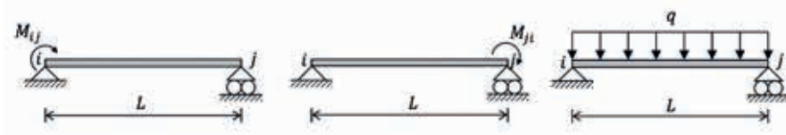
Kuvio 2. Sauvan kuormituksena sauvanpäämomentit ja tasainen kuorma.
