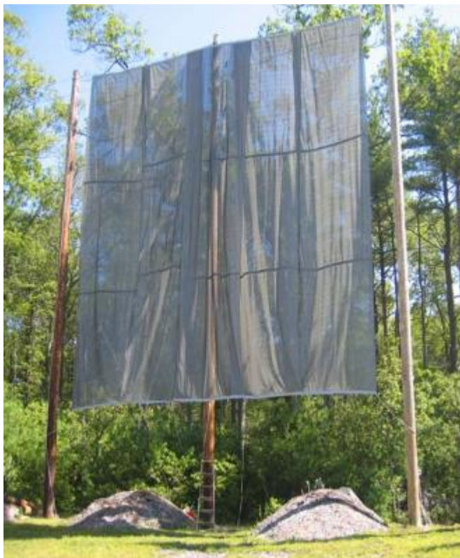
Kuva 7. Haulien pysäyttämistä varten rakennettu verhojärjestelmä (Kim & Lewis 2006)
