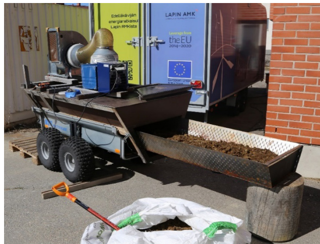
Kuva 1. Alipainekuivuria käytettiin pientestauksessa hevoselannan kuivaamiseen (Ranta 2020)
