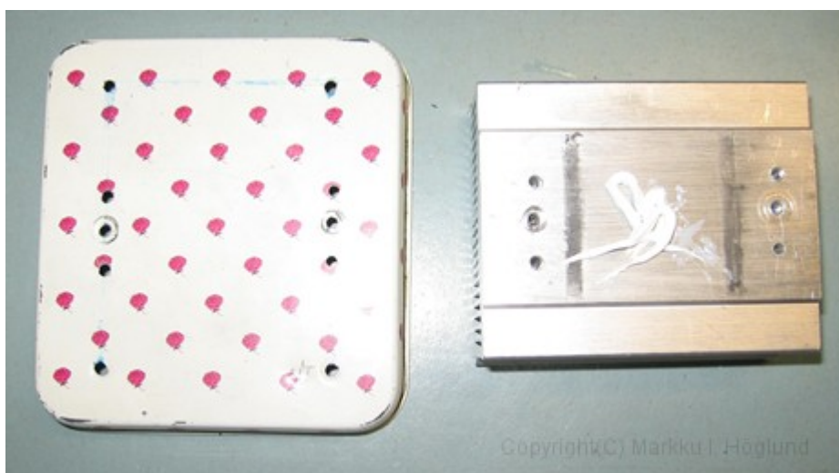
Kuva 12. Kansi ja jäähdytysprofiili
