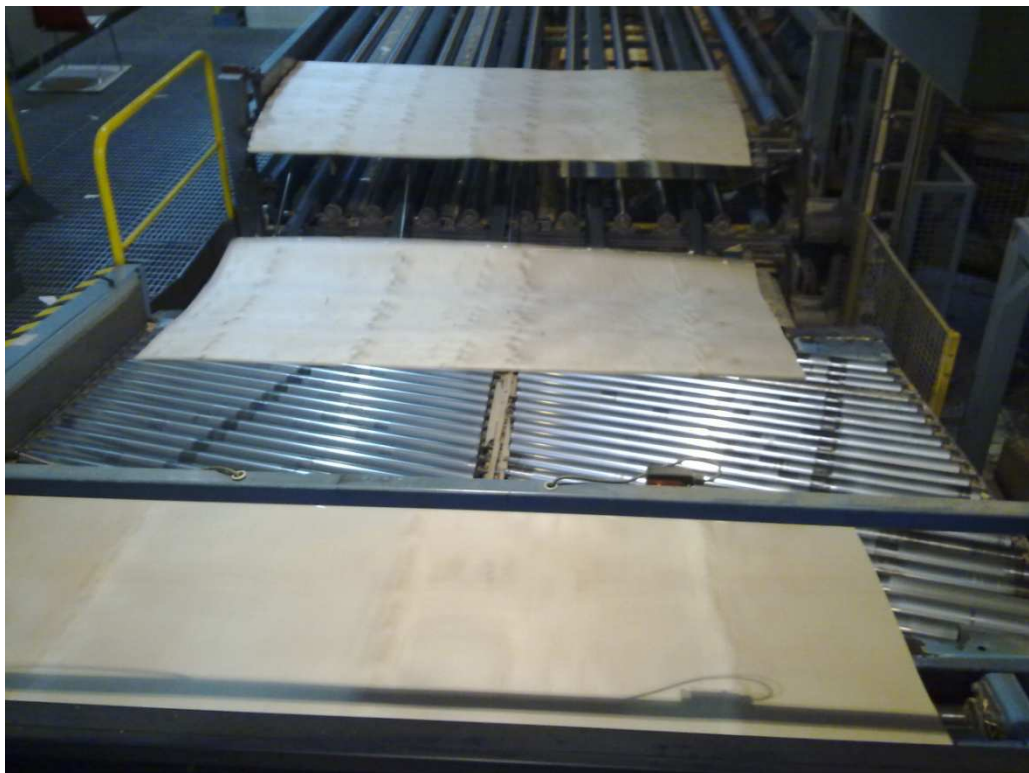
Kuva 4. Kuusivanerista sorvattua viilua. Kuvan otti Satu Muranen-Granö
