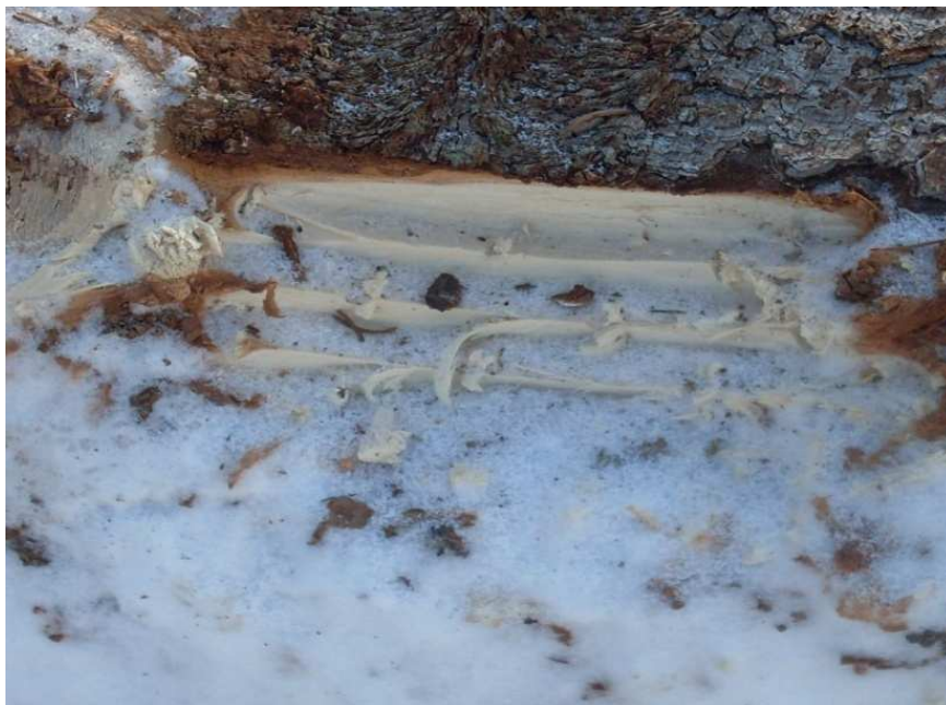
Kuva 2. Syöttörullavaurio. Kuvan otti Satu Muranen-Granö
