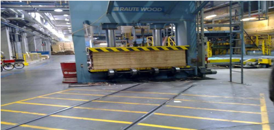
Kuva 5 Vanerilevyaihio prässissä. Kuvan otti Satu Muranen-Granö
