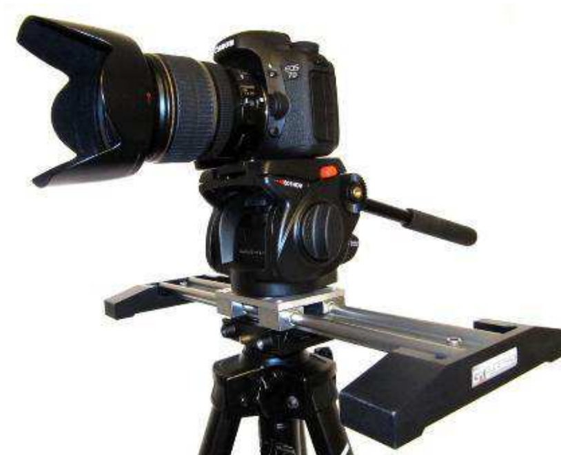
Kuva 17. Kuvassa pocket dolly kiinnitettynä kolmijalkaiseen jalustaan. ( http://thediff.files.wordpress.com )
