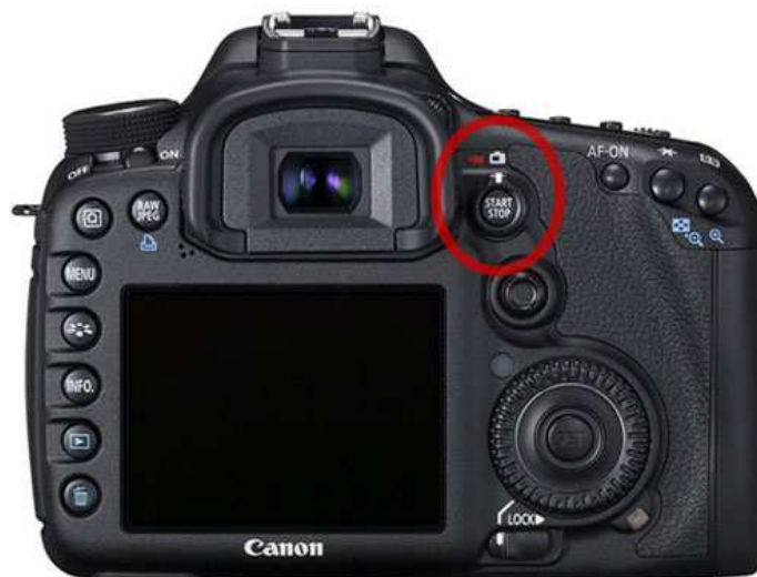
Kuva 4. Canon 7D takapaneeli. Kuvassa punaisella ympyröitynä kameran videokytkin. ( http://www.bhphotovideo.com )
