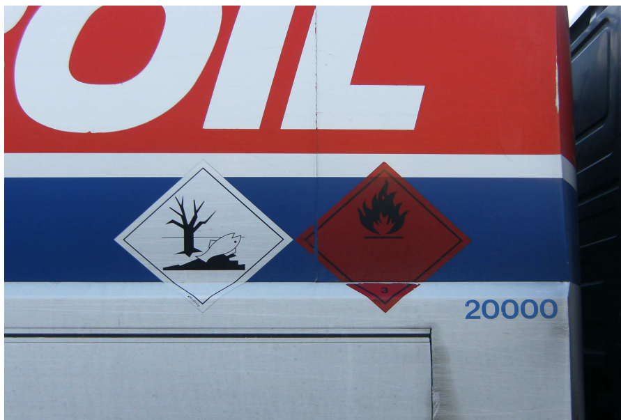
Kuva 1. Suurlipukkeet säiliöajoneuvon sivussa.
