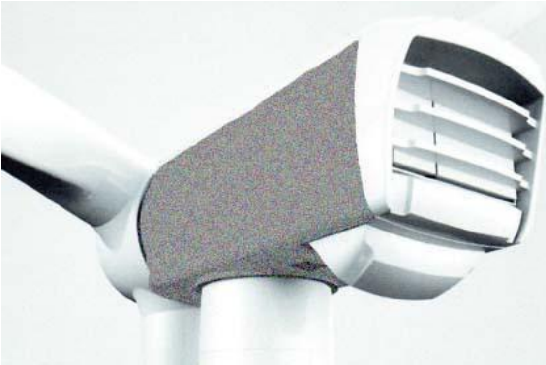
Kuva 4. Nacellin alumiinikuoret tummennettuna.
