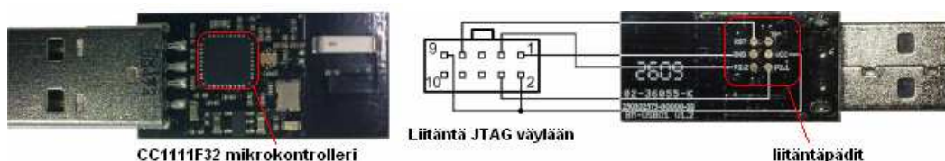
KUVA 4. Chronos eZ430 RF-osa ja debuggeri- liitäntäpädit (1, s.59)
