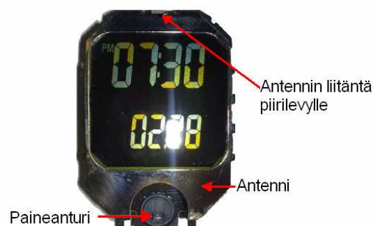
KUVA 6. Kellon näyttö ja sitä ympäröivä antenni (1,s.57)
