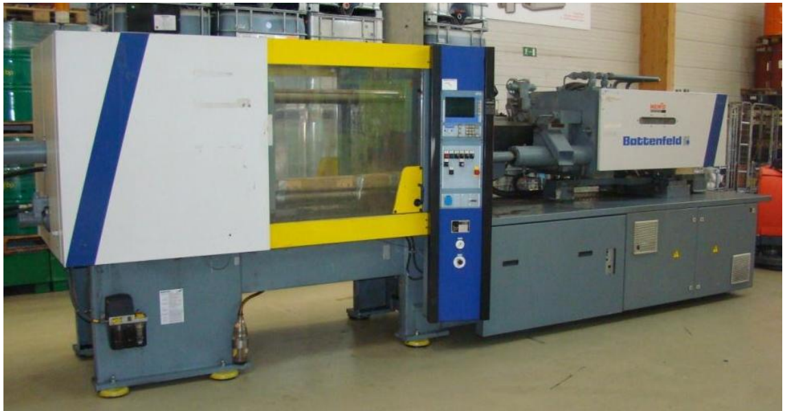
Kuva 3. Battenfeld BK-T 1800 / 1000 ruiskuvalukone. (www.equipmatching.com, muokattu)
