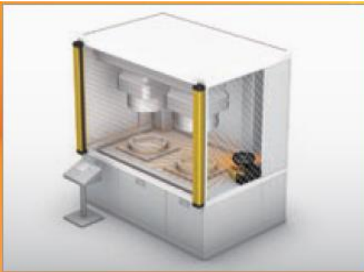
Suojaaja koneen sisäpuolella
