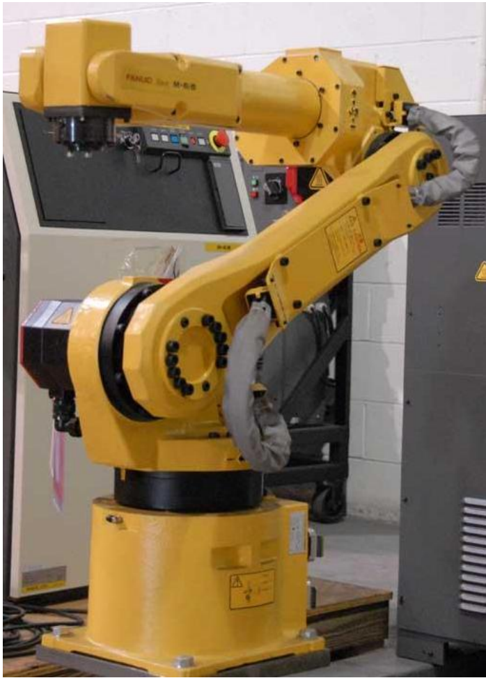
Kuva 1. Fanuc M-6iB robotti. (www.robots.com, muokattu)
