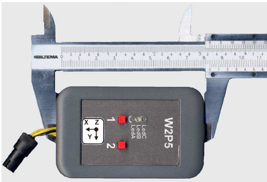
KUVA 3. Tutkimusvaiheen impedanssipneumografi on kannettava mittalaite. Sen paino ilman mittausjohtoja ja elektrodeja on 48 g. (Vuorela ym. 2010, 720)
