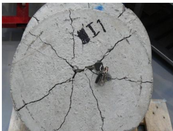
Testauskuva 16. Virheellinen tulos (liian lyhyt testiaika), painuma 12.92 mm ja voima 84.71 kN.
