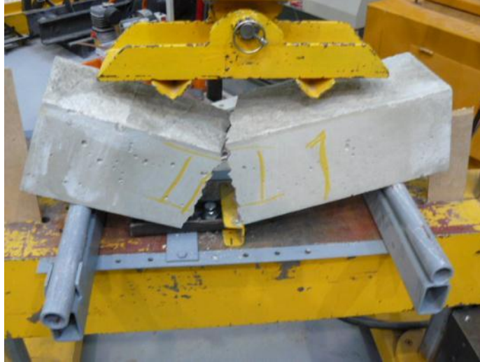
Testauskuva 11. Painuma 2.44 mm, voima 22.93 kN.
