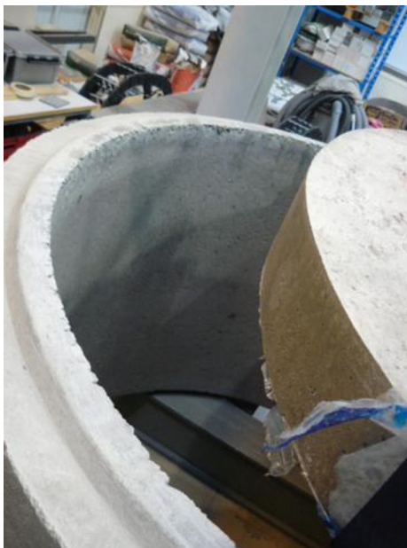
Kuva 14. Betonirenkaan reuna oli tarkoitukseemme aivan liian epätasainen ja karkea. Tasoitin reunan ja täytin reunassa olevat kolot kaksikomponenttimassalla, mikä oli lujuudeltaan betonin kaltaista.
