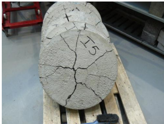
Testauskuva 20. Painuma 17.58 mm, voima 75.76 kN.
