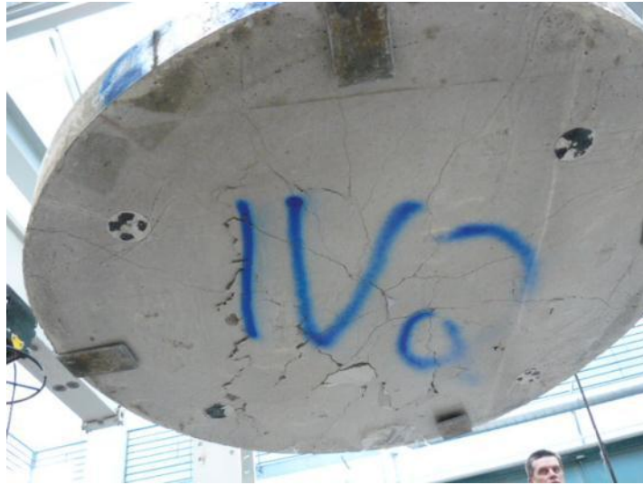
Testauskuva 41. Painuma 30.45 mm, voima 199.07 kN.
