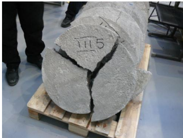
Testauskuva 30. Painuma 2.92 mm, voima 53.18 kN.
