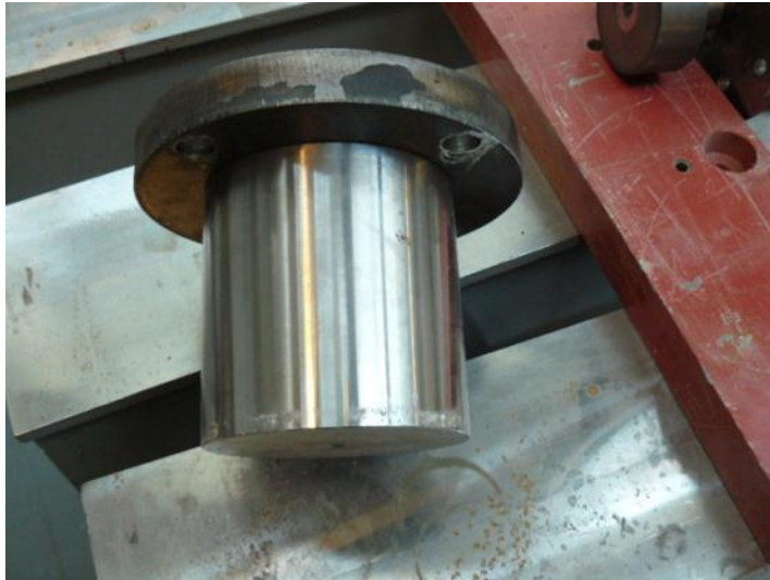
Kuva 9. Suurten (1600mm) laattojen testaamiseen tarvittiin sylinterin karaan laipalla kiinnitettävä 150mm halkaisijaltaan oleva umpiteräksinen kärki.
