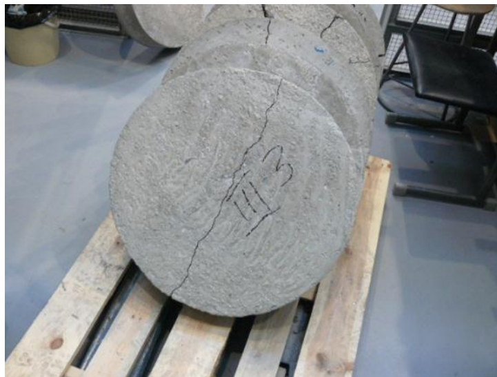
Testauskuva 28. Painuma 3.55 mm, voima 54.16 kN.
