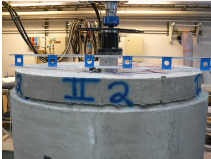
Testauskuva 35. Painuma 49.76 mm, voima 119.83 kN.
