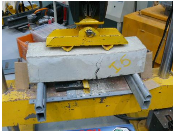
Testauskuva 5. Painuma 7.96 mm, voima 32.16 kN.
