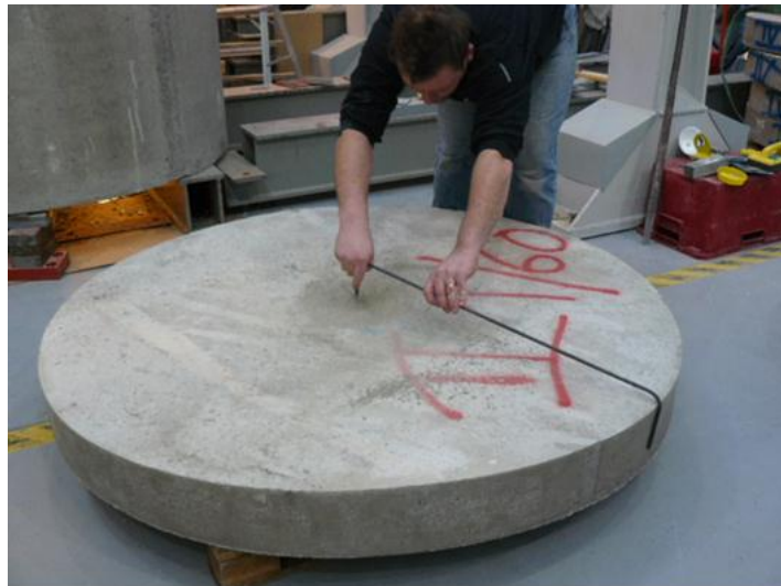
Kuva 15. 1600 mm laattojen keskikohdan merkitsin 800mm pitkällä piirtoraudalla 6:sta eri kohdasta laatan reunoilta.
