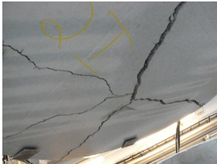
Testauskuva 32. Painuma 46.53 mm, voima 85.35 kN.
