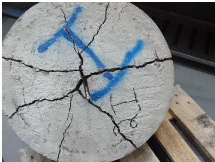
Testauskuva 17. Painuma 21.86 mm, voima 77.09 kN.
