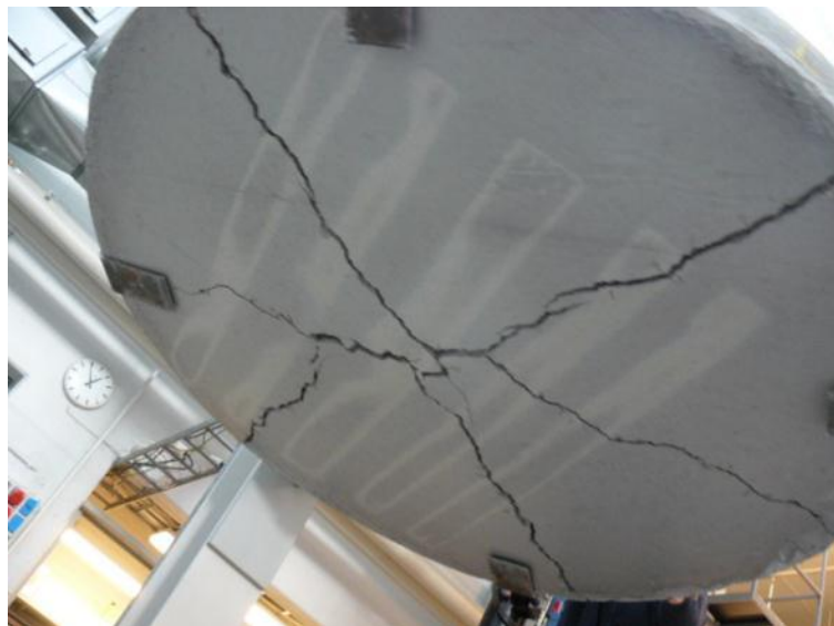
Testauskuva 33. Painuma 45.35 mm, voima 98.69 kN.
