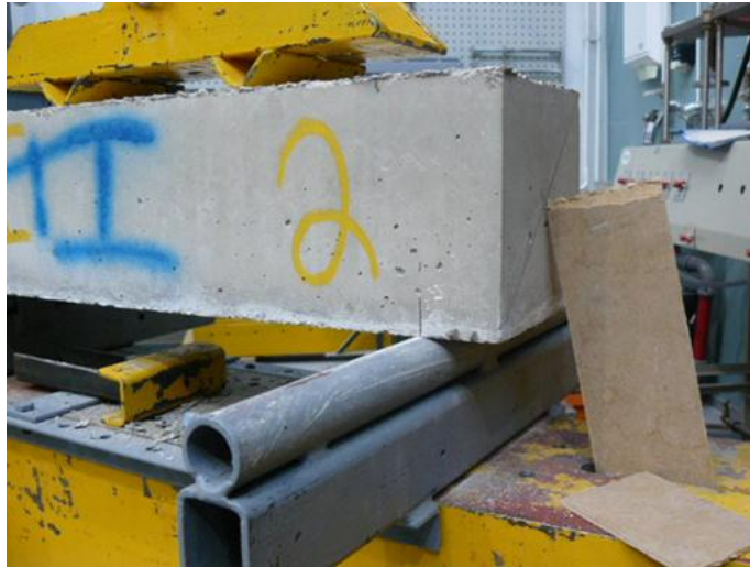
Testauskuva 7. Painuma 9.09 mm, voima 38.41 kN.
