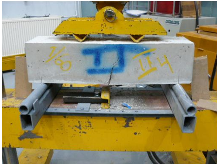
Testauskuva 9. Painuma 5.64 mm, voima 29.95 kN.
