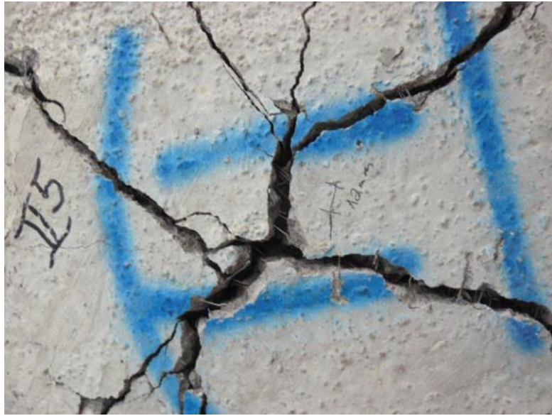
Testauskuva 25. Painuma 22.78 mm, voima 80.90 kN.
