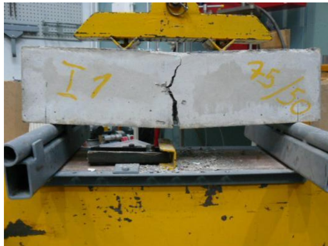
Testauskuva 1. Painuma 9,61 mm, voima 27,95 kN.
