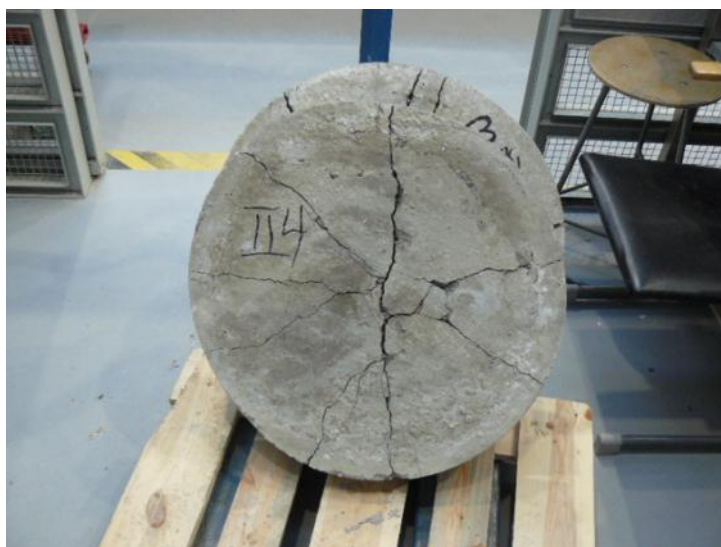
Testauskuva 24. Painuma 14.94 mm, voima 76.61 kN.
