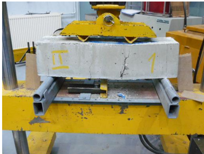
Testauskuva 6. Painuma 9.35 mm, voima 47.30 kN.
