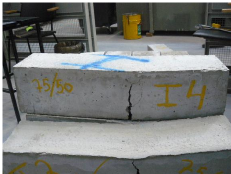
Testauskuva 4. Painuma 7.91 mm, voima 32.77 kN.
