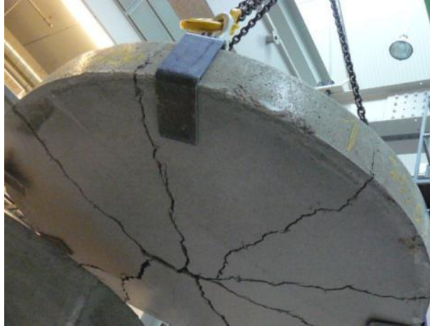
Testauskuva 31. Painuma 18.71 mm, voima 110.61 kN.
