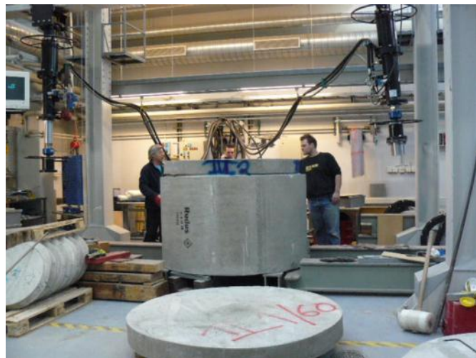
Testauskuva 38. Painuma 4.43 mm, voima 72.08 kN.
