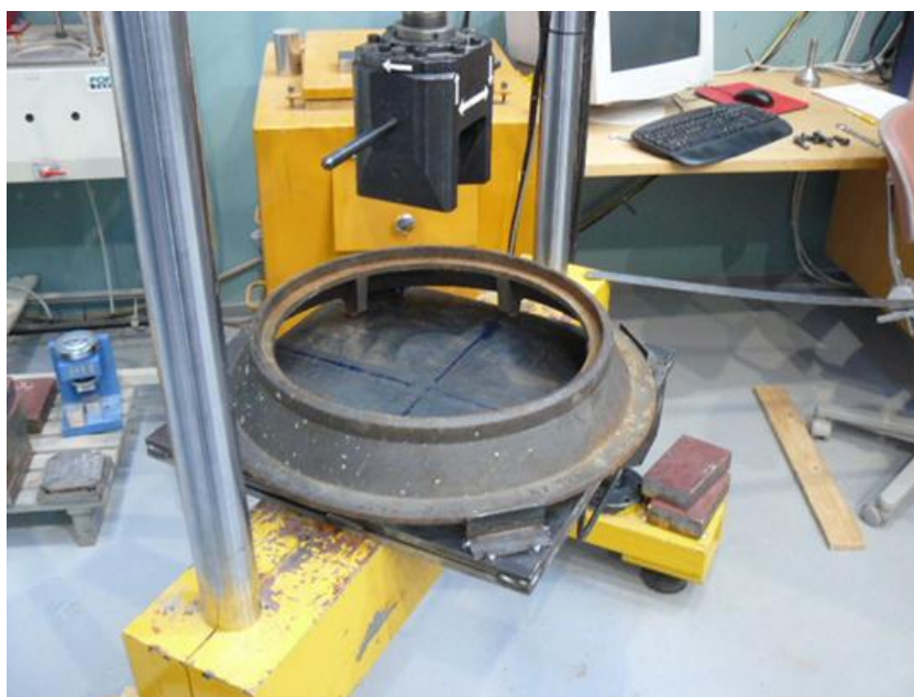
Kuva 7. Projektipalvelu Tila Oy toimitti juuri mittoihin sopivan valurautarenkaan, sisähalkaisijaltaan 500mm ja seinämä paksuudeltaan 5mm.
