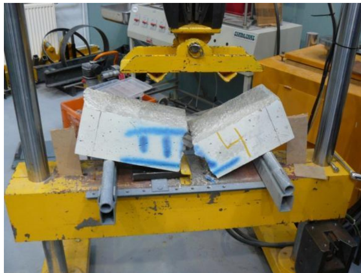
Testauskuva 14. Painuma 2.40 mm, voima 26.37 kN.
