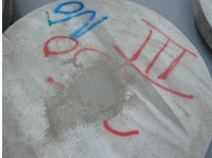
Testauskuva 37. Painuma 3.68 mm, voima 62.44 kN.
