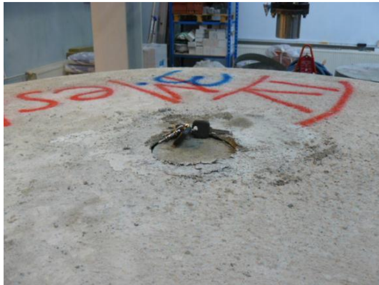
Testauskuva 42. Painuma 26.04 mm, voima 183.17 kN.
