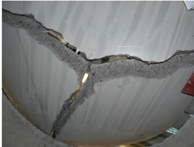
Testauskuva 39. Painuma 3.83 mm, voima 77.96 kN.
