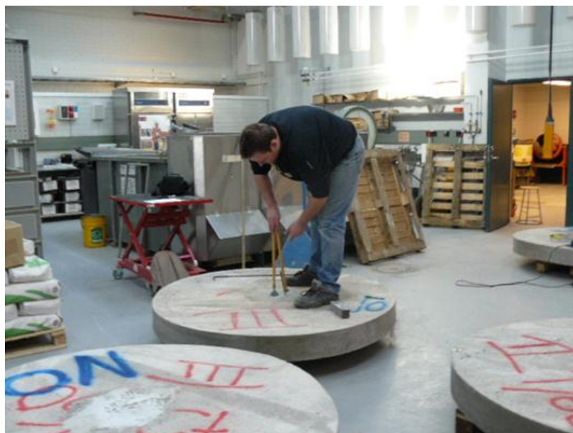
Kuva 16. Keskipisteestä piirsin 150mm halkaisijaltaan olevan ympyrän, josta pystyimme keskittämään puristuskohdan tarkalleen.
