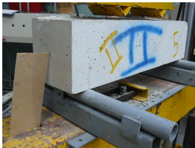
Testauskuva 10. Painuma 8.07 mm, voima 31.84 kN.
