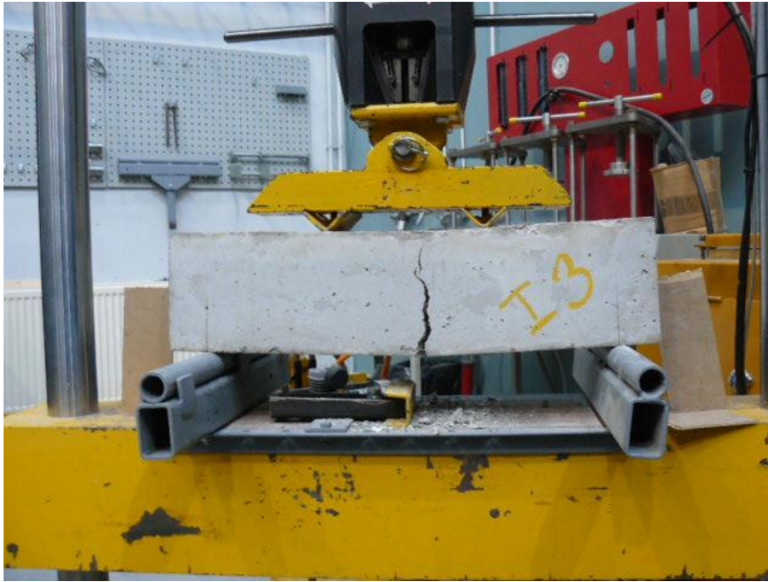
Testauskuva 3. Painuma 8.05 mm, voima 32.59 kN.
