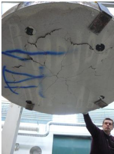
Testauskuva 40. Painuma 31.55 mm, voima 189.77 kN.
