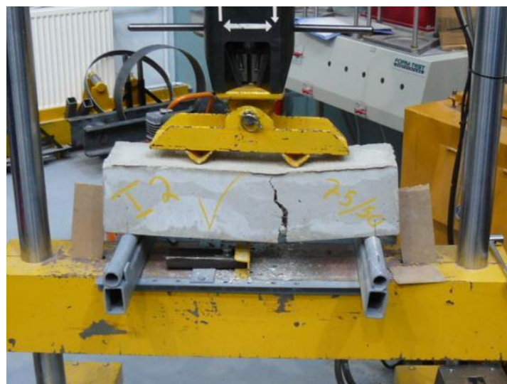
Testauskuva 2. Virheellinen tulos (Testi liian nopea). Painuma 7.88 mm, voima 10.60 kN3.
