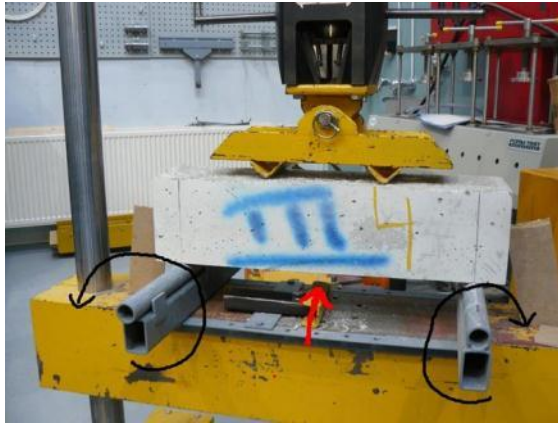
Kuva 11. Tukipintakehikko jousti palkkeja koeponnistaessa nuolien osoittamalla tavalla.
