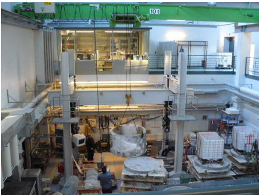
Kuva 13. Suurten 1600mm laattojen puristusaluksena käytettiin 1500mm sisähalkaisijaltaan olevaa betonista valmistettua kaivonrengasta.
