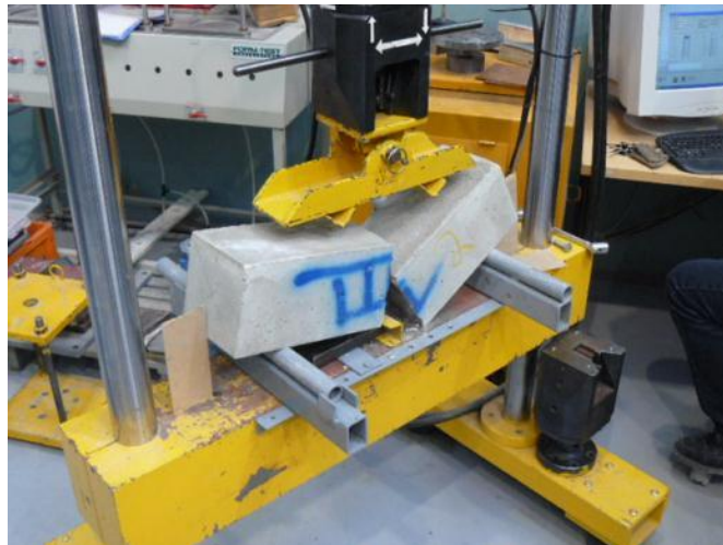
Testauskuva 12. Painuma 3.79 mm, voima 27.83 kN.
