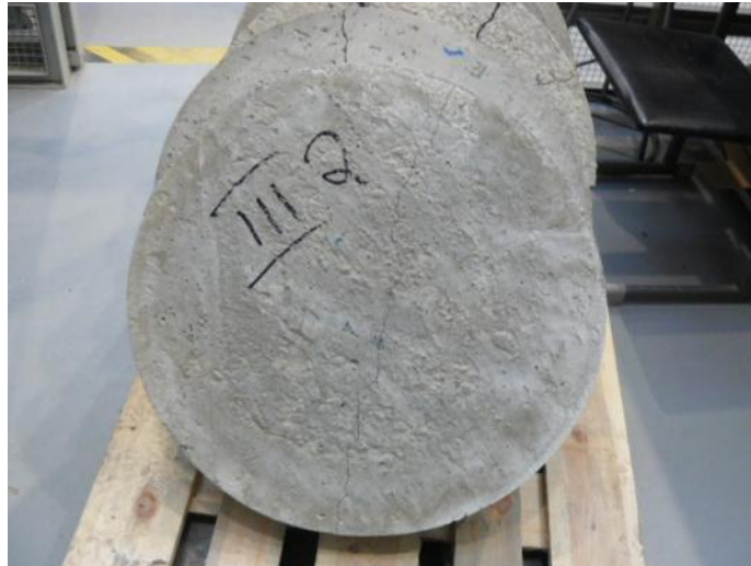
Testauskuva 27. Painuma 2.05 mm, voima 48.00 kN.
