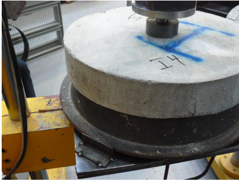
Testauskuva 19. Painuma 20.77 mm, voima 76.15 kN.
