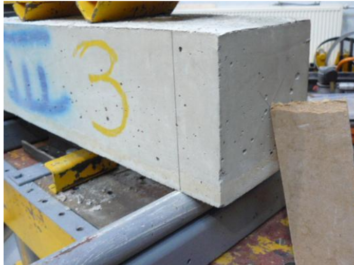
Testauskuva 13. Painuma 2.55 mm, voima 25.51 kN.
