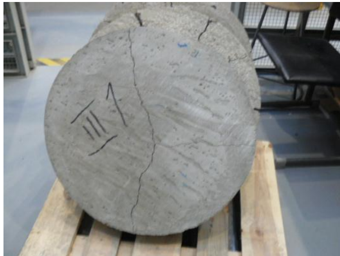
Testauskuva 26. Painuma 3.23 mm, voima 55.55 kN.
