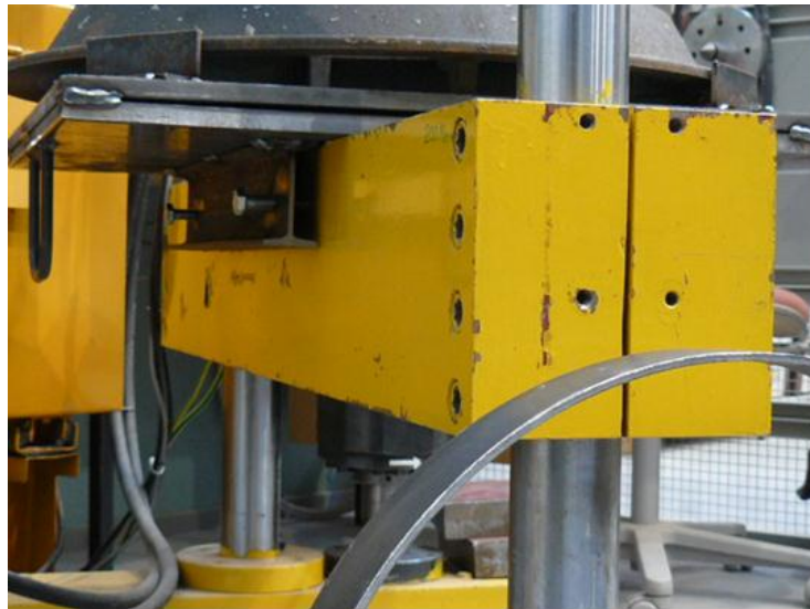
Kuva 8. Suunnittelemani ja Länsiväylän Metalli Oy:n valmistama pohjalevy on tässä kiinnitettynä ja kohdistettuna puristuslaitteistoon.
