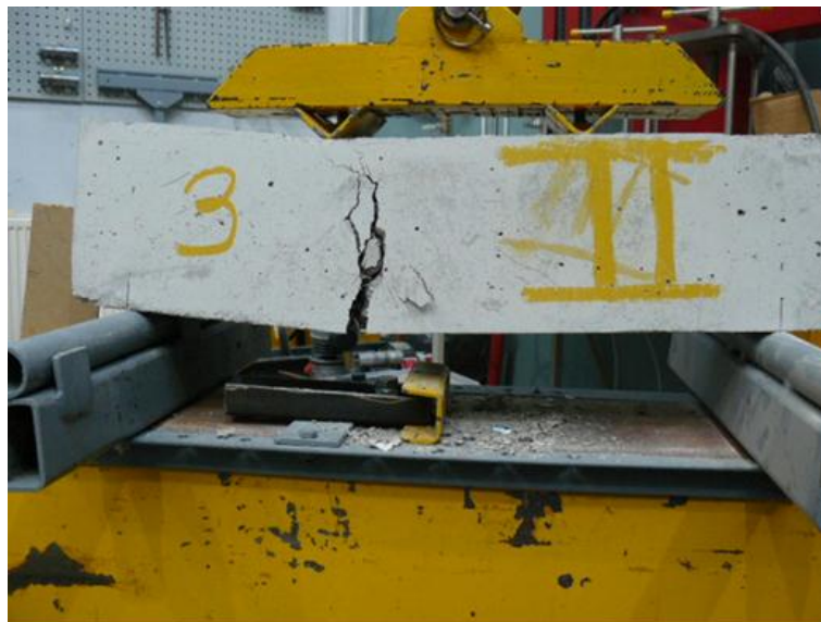
Testauskuva 8. Painuma 11.83 mm, voima 38.15 kN.
