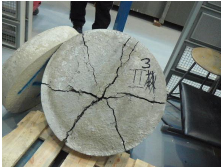
Testauskuva 23. Painuma 21.06 mm, voima 69.29 kN.
