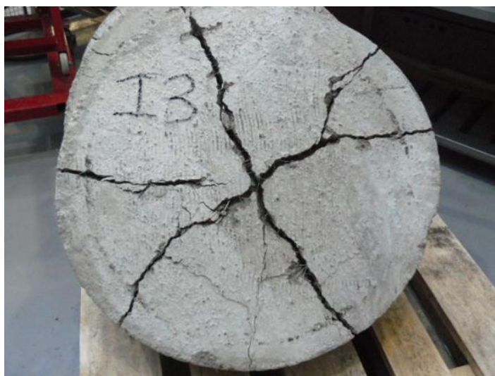
Testauskuva 18. Painuma 19.65 mm, voima 90.49 kN.
