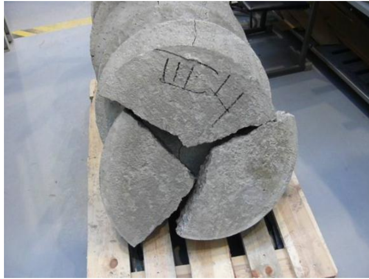
Testauskuva 29. Painuma 3.14 mm, voima 54.70 kN.
