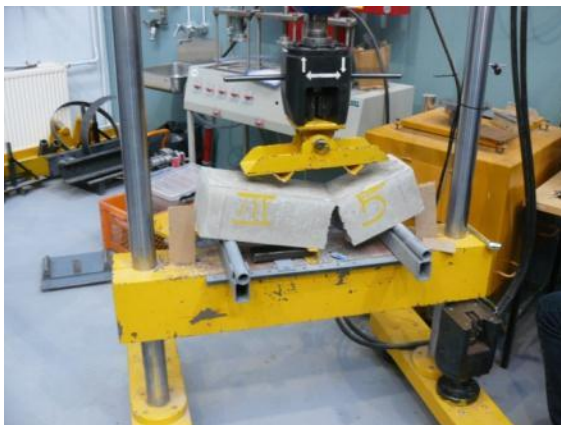
Testauskuva 15. Painuma 1.63 mm, voima 22.37 kN.
