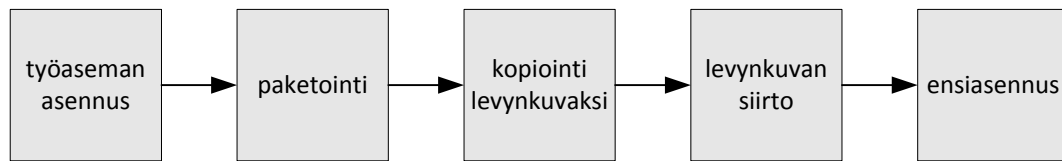
Kuva 12. Työvaiheet työaseman asennuksesta ensiasennuspaketin käynnistykseen.
