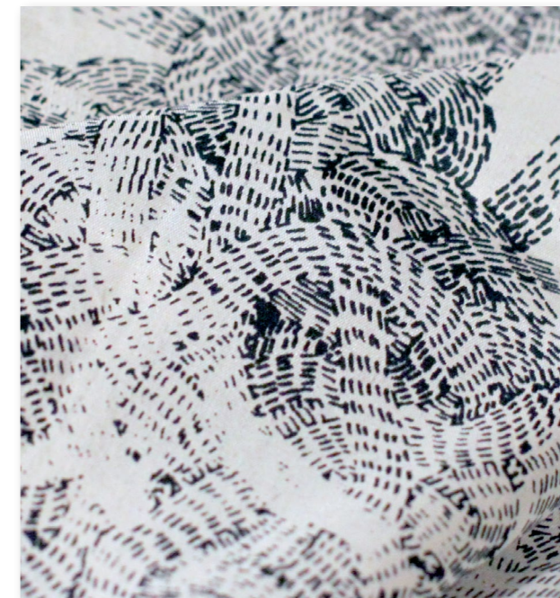
Valokuva epäonnistuneesta Sykkyrä-kuosin painojäljestä. Kuvassa näkyy kuinka väri ei ole tarttunut joihinkin kohtiin lainkaan, ja joissakin sitä on liikaa.
