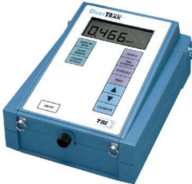
Kuvio 4: Kontrollilaitteena toimiva DustTrak.
