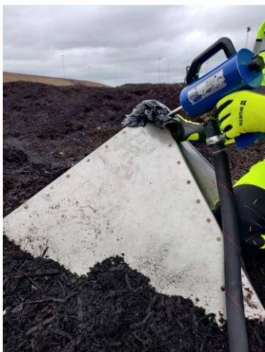
Kuva 7. Mittausta kompostiaumasta huuvan avulla
