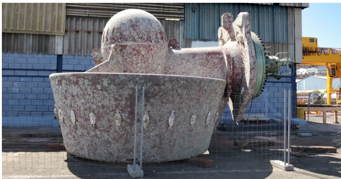
Kuva 7. UUC-potkurilaite odottamassa määräaikaishuoltoa
