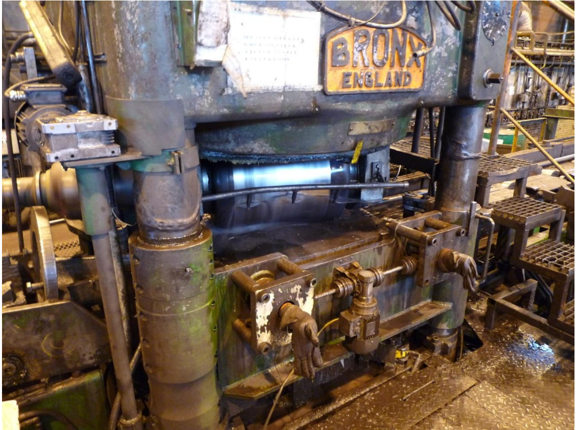
Kuva 11. Bronx-6 oikaisukoneen tolpassa olevat anturit.
