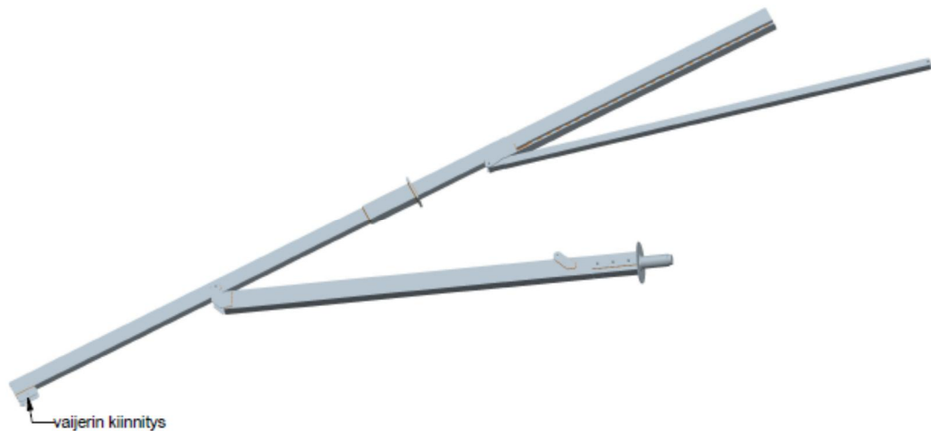
Kuva 33. Nosturin yläosa (vinotuki alapäästä irrallaan).
