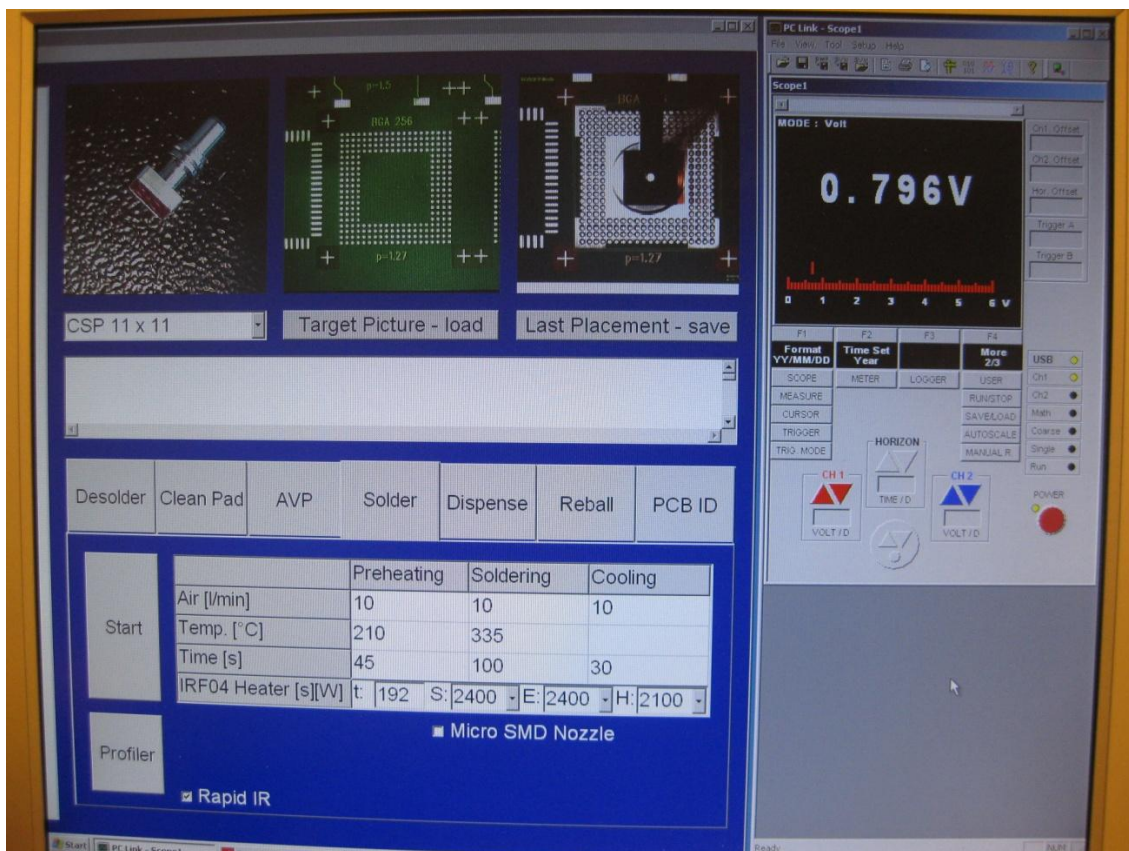
KUVA 11. EasySolderin profiilinohjauksen käyttöliittymä vasemmalla. Oikealla puolella on Agilent U1604A -digitaalioskilloskoopin käyttöliittymä
