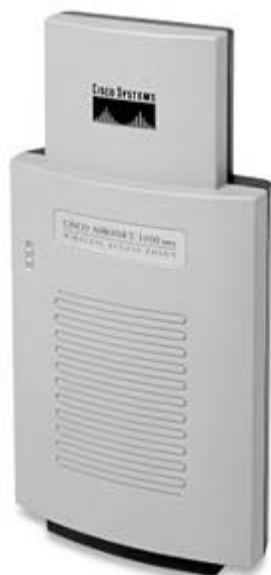
Kuvio: Cisco Aironet 1100 -sarjan WLAN-tukiasema (Cisco Aironet 1100 Series Access Point Data Sheet. Cisco)
