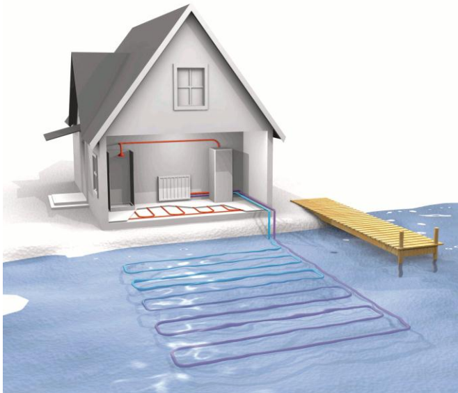
KUVA 4. Talon lämmitystarpeet vaikuttavat asennettavan lämmönkeruuputkiston pituuteen (19)
