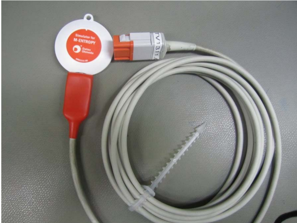
Kuva 5. Entropia-moduulin EEG-simulaattori ja kaapeli
