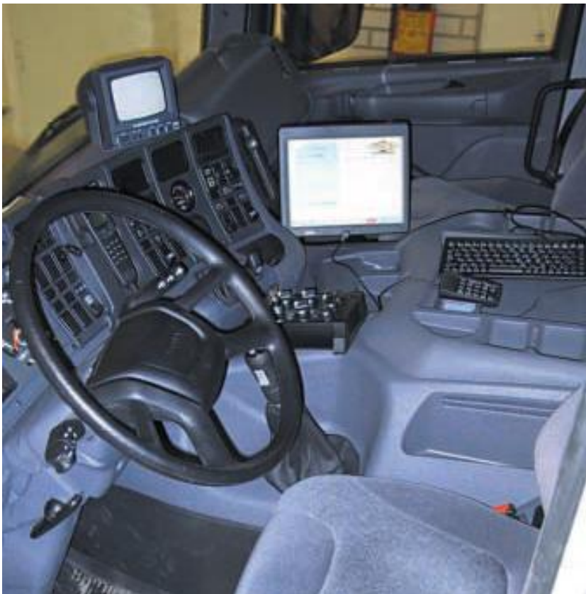
Kuva 7. Ajoneuvotietokone ja TCS-järjestelmästä auton sisäkuva.
