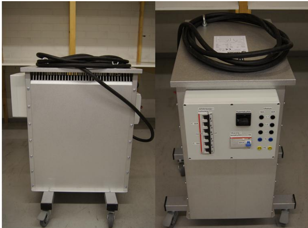
Kuva 2. Suojaerotusmuuntaja kuvattuna sivusta ja toisiopuolelta.
