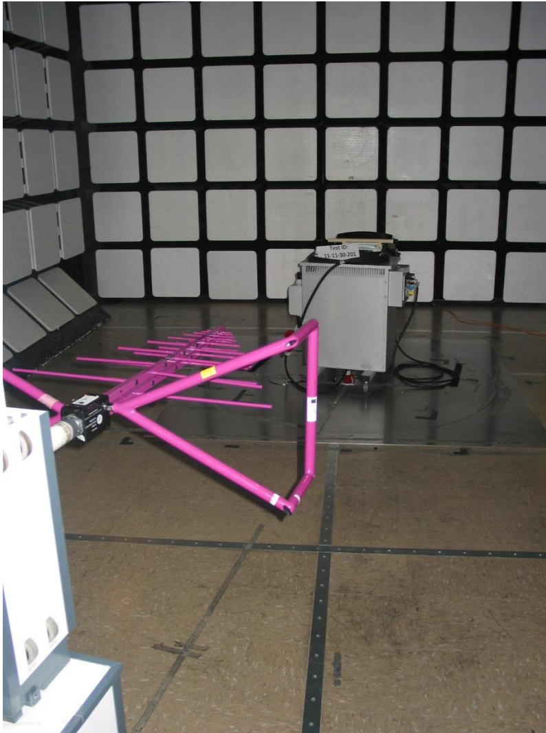
KUVA 12. Säteilevän emission testiasetus
