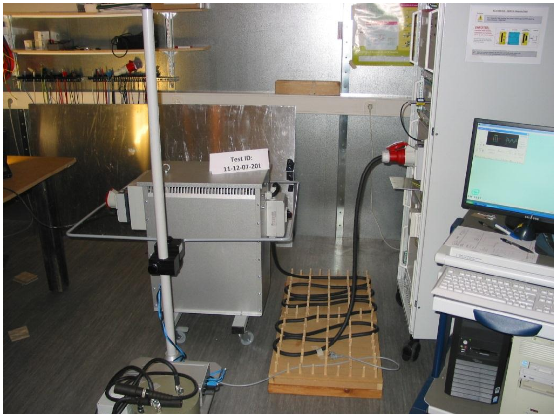
KUVA 16. Verkkotaajuisen magneettikentän siedon mittausasetelma, X-polarisaatio
