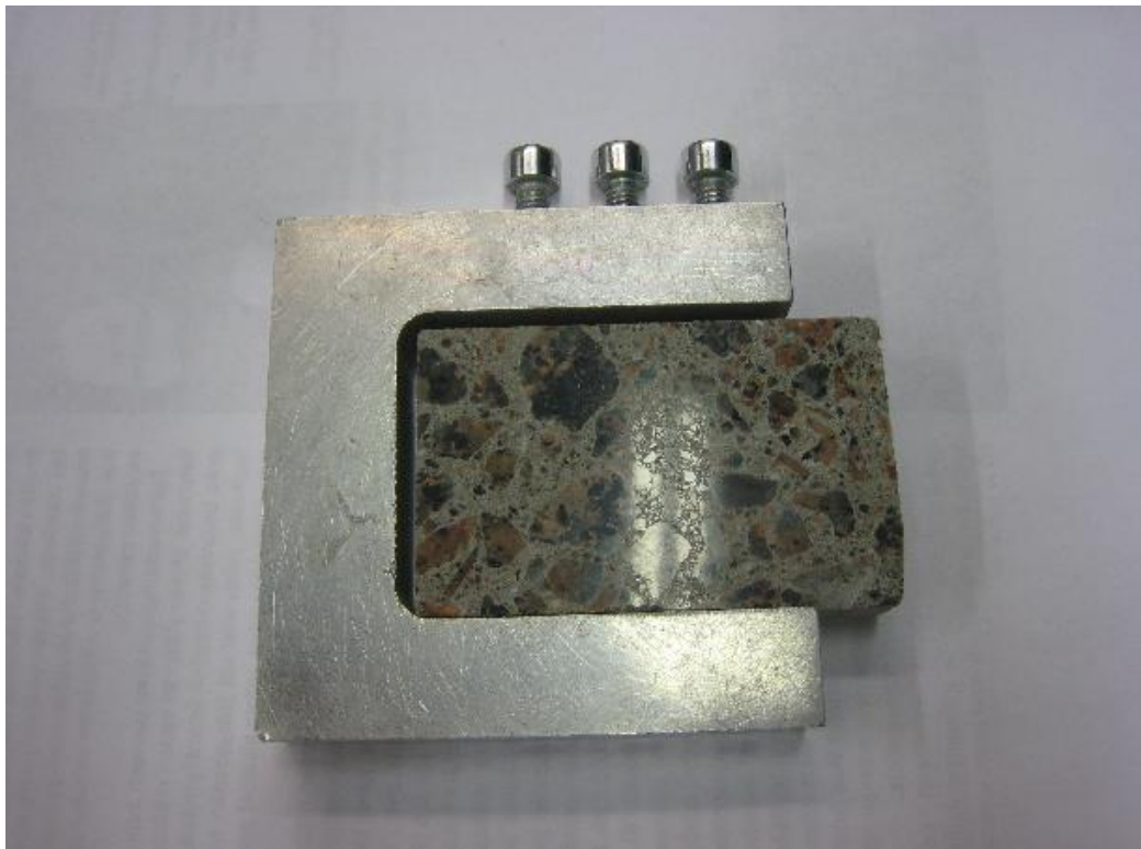
Kuva 24 Poranäytteestä tehty pintahie laskentavalmiina huukosjaon määrittystä varten (Maasilta 2009.)
