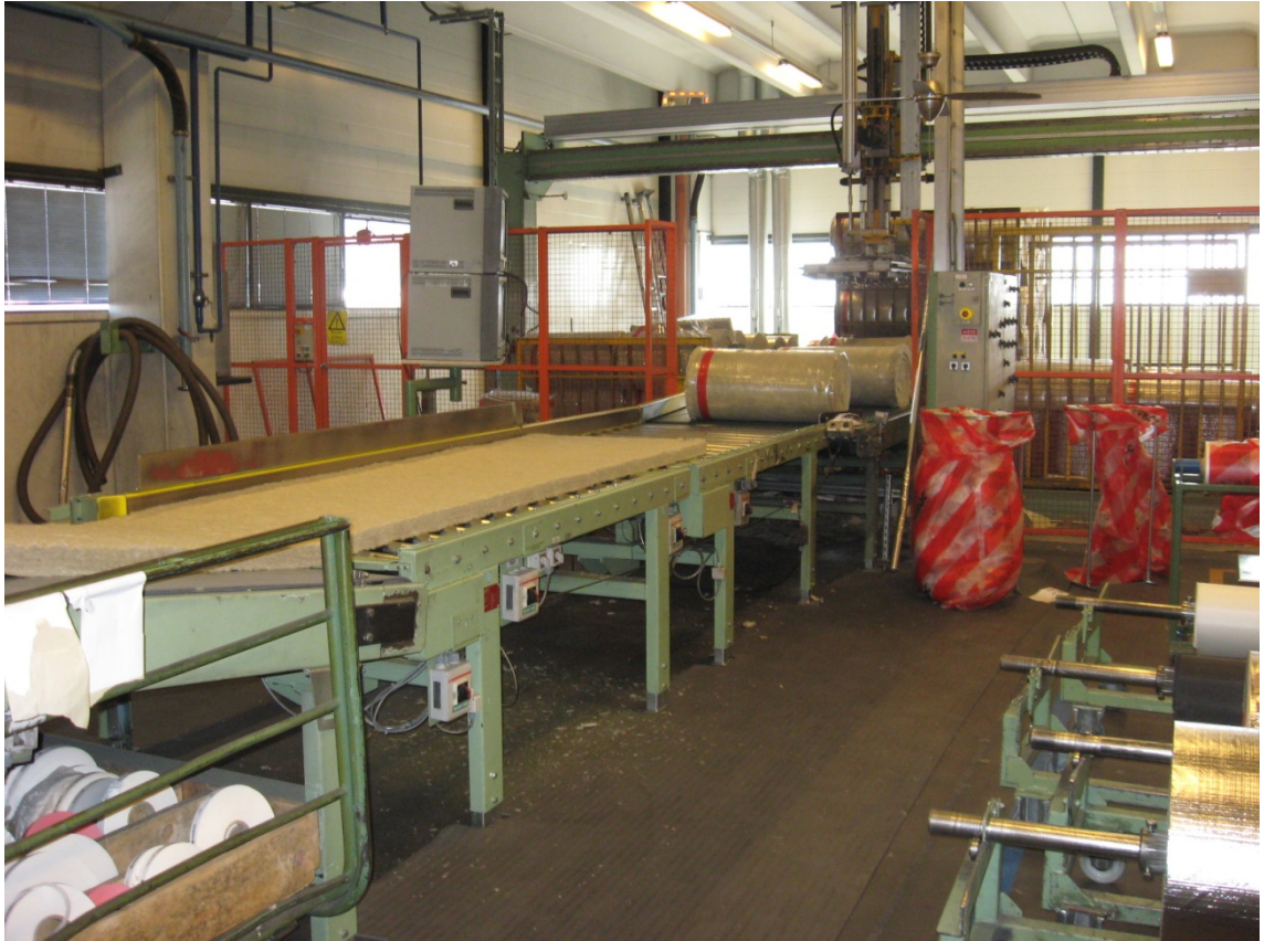
Kuva 1. Portaalirobotti ja paketointimuovin poistopaikka
