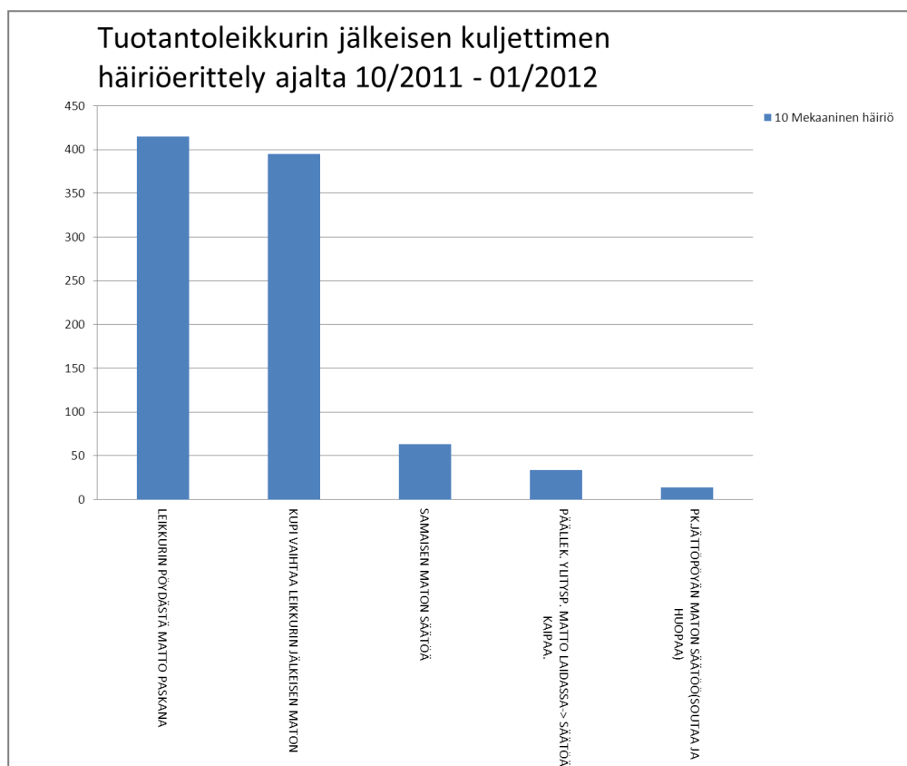
Kuva 16. Tuotantoleikkurin jälkeisen kuljettimen häiriöerittely välillä lokakuu 2011 - tammikuu 2012
