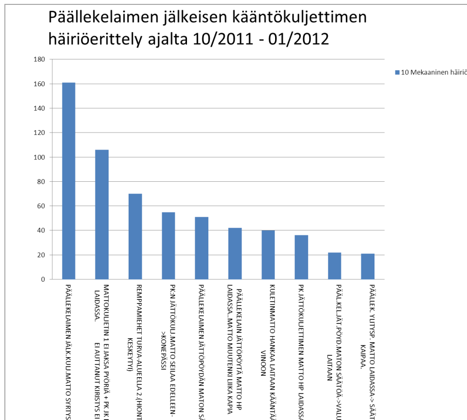
Kuva 18. Päällekelaimen jälkeisen kuljettimen häiriöerittely välillä lokakuu 2011 - tammikuu 2012
