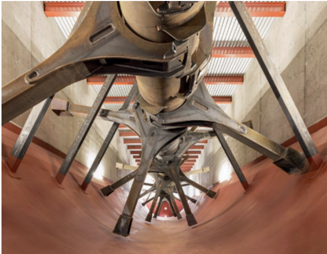
Kuva 20. Thöniin kuivamädätysreaktorin rakenne (Thöni Industriebetriebe GmbH, 2020).
