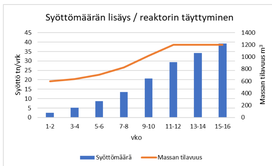
Kuva 27. Kuvaaja reaktorin täyttymisestä, kun kuormitusta nostetaan 14 vrk välein 1 kgVS/(m 3 vrk).
