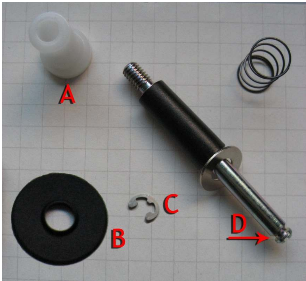
Kuva 18. Seimitsu LS-33 ohjainsauvan aktuaattori (A), pölysuoja (B), rengassokka (C), ohjainsauvan hahlo (D), johon rengassokka kiinnittyy, sauva sekä jousi.
