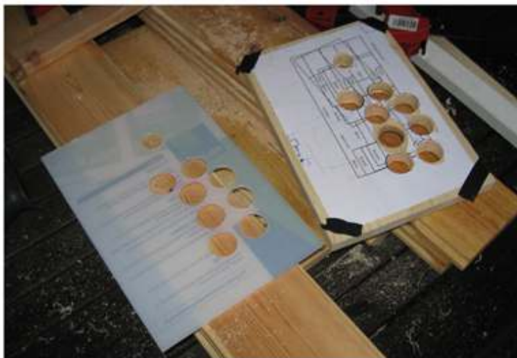
Kuva 32. Kansilevyn sekä sen päälle tulevan polykarbonaattilevyn porausjärjestelyt.
