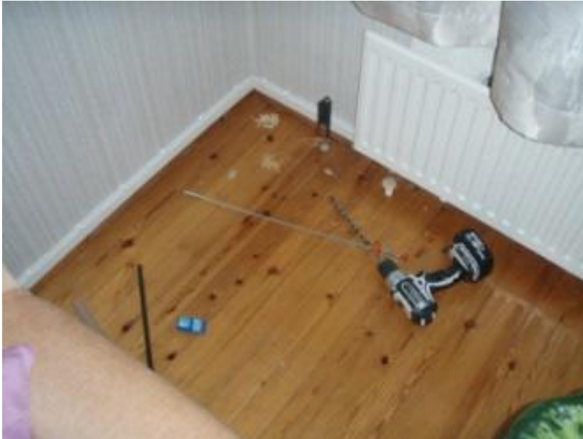
KUVA 6. Puukoolatun lattian kosteudenmittaus (Tissari 2011)
