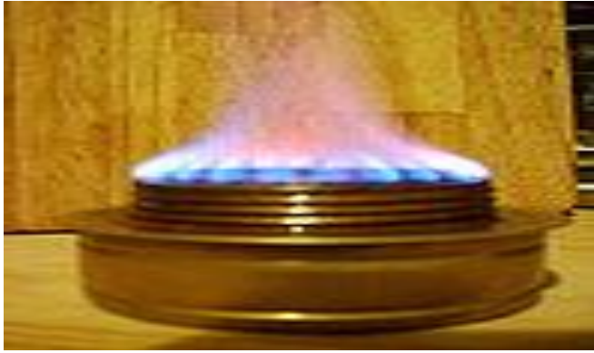
KUVA 4. Spriikeitin jolla ruoka lämmitetään tai keitetään trangiaassa (Wikipedia 2011).
