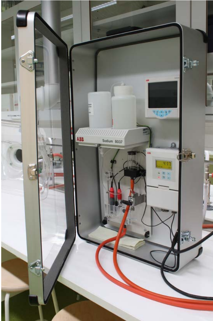
Kuva 2, natrium-analysaattori on asennettu siirrettävälle alustalle.
