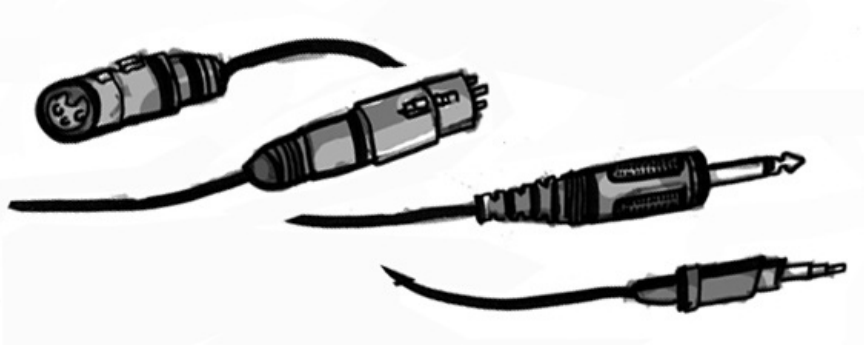
Vasemmalta oikealle: XLR-liittimen naaras- ja uroskappaleet, plugi, miniplugi.
