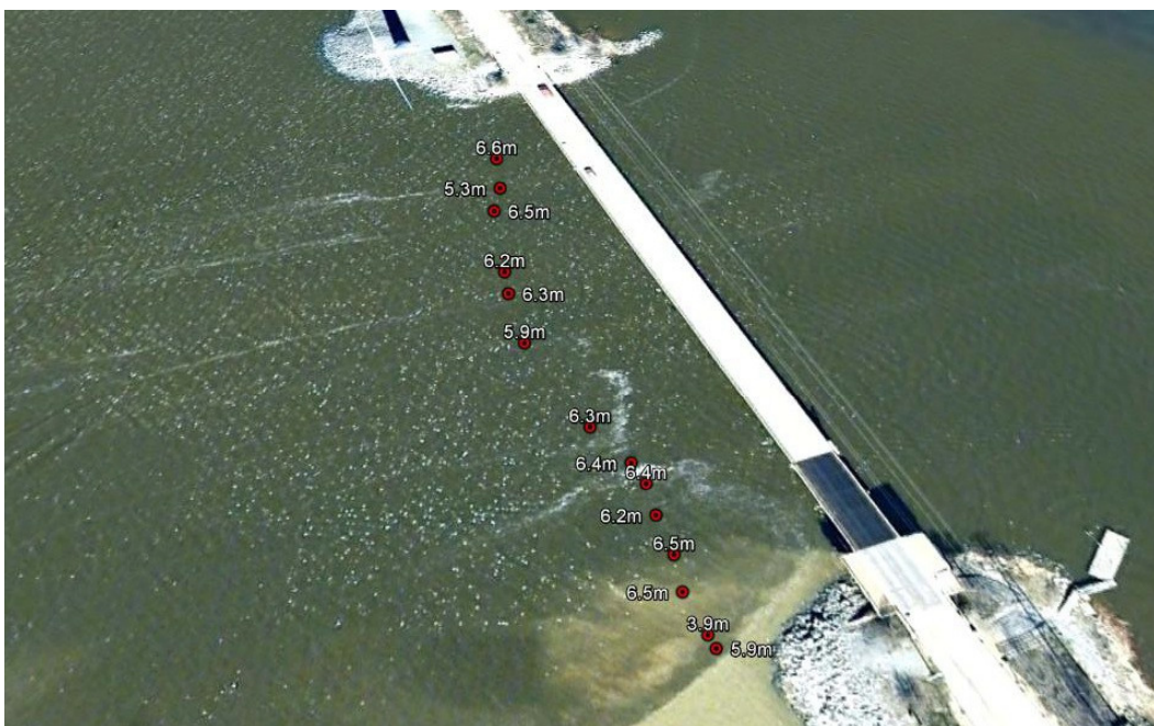
Kuva 8.1 Havainnekuva, Kaapelin sijaintipisteitä syvyysmerkinnöillä
