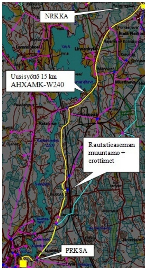
Kuva 33. Nerkoon kytkinaseman uusi syöttö.
