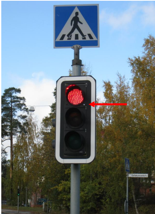
Kuva 7. Kuva Pirkankadun ja Satakunnankadun risteyksessä olevasta pääopastimesta, jossa nähdään punaisenvalon alakulmassa pieni kirkas Led – valo, joka osoittaa linja-auton kuljettajalle hänen saaneen etuuden kyseiseen risteykseen. (Risteyksestä 310 Pirkankatu – Satakunnankatu Tampere)
