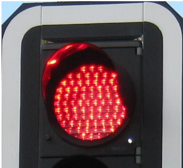
Kuva 8. Kuva Pirkankadun ja Satakunnankadun risteyksessä olevasta pääopastimesta, jossa nähdään punaisenvalon alakulmassa pieni kirkas Led – valo, joka osoittaa linja-auton kuljettajalle hänen saaneen etuuden kyseiseen risteykseen. (Risteyksestä 310 Pirkankatu – Satakunnankatu Tampere)
