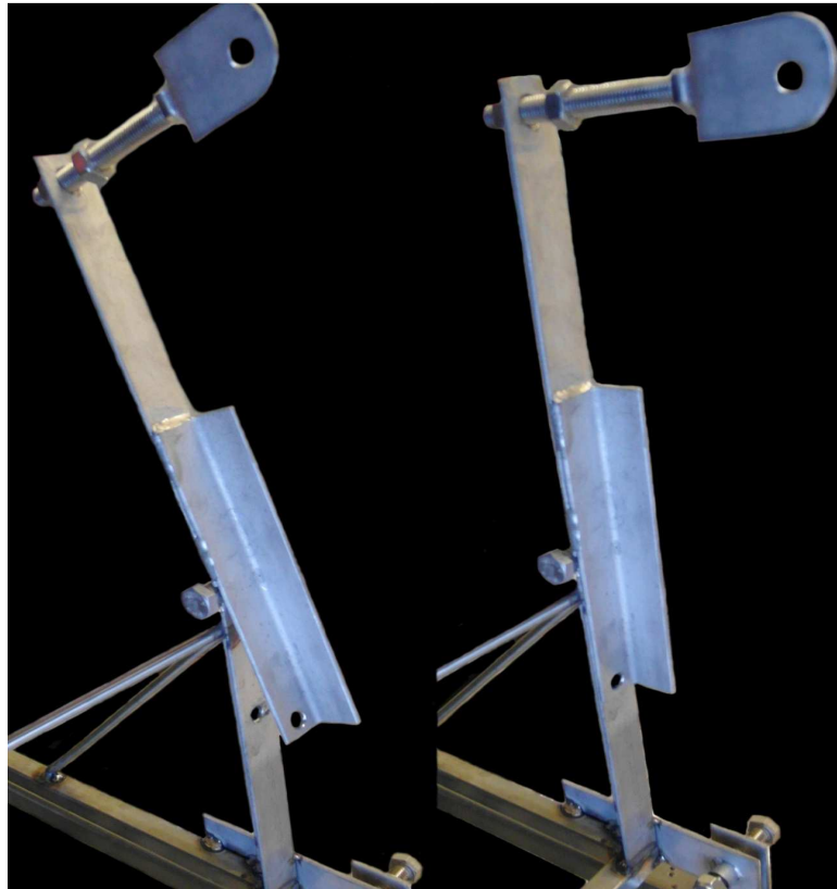
Kuva 11. Nivellyt vipuvarsi, johon karamoottori kytketään toisesta päästä; Vipuvarren avulla karamoottori avaa ja sulkee kammiota. Kuvassa oikeanpuoleinen nivel on perusasennossa ja vasemmanpuoleinen nivel on hieman avautuneena. Vipuvarren yläpäässä on kiinnityspaikka karamoottorille. Nivelen alapuolella on vipuvarteeseen porattu reikä, johon voidaan kiristää pultti, mikäli nivel halutaan lukita.
