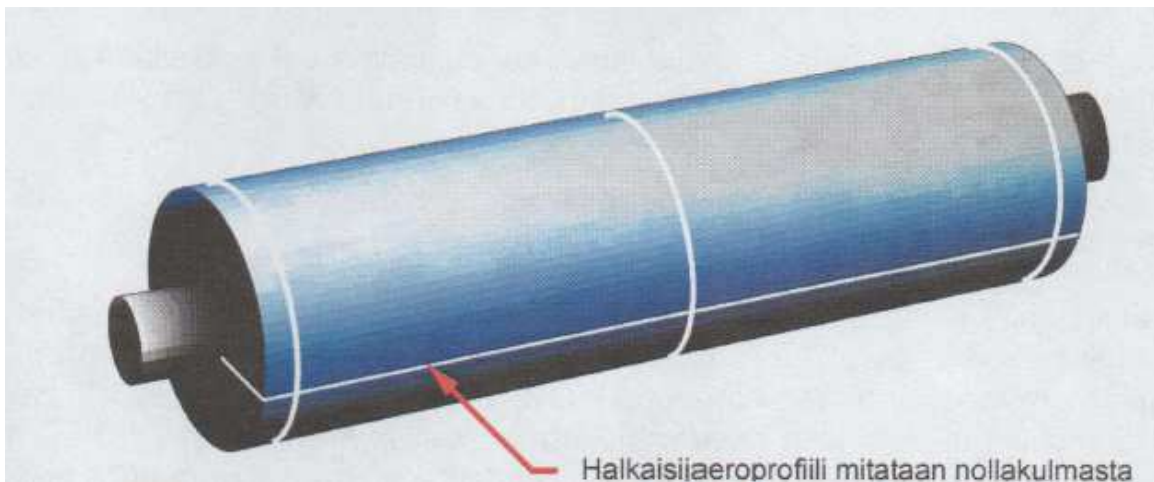
KUVA 24. Halkaisijaeroprofiili sekä ympyrämäisyysprofiilit molemmista päistä ja keskeltä mitattuna. (RollResearch, 2003, 32.)
