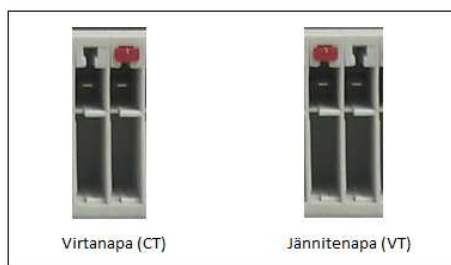
Kuvio 4. Muuntajamoduulin kortin reunaliittimen virta- ja jännitenapa.
