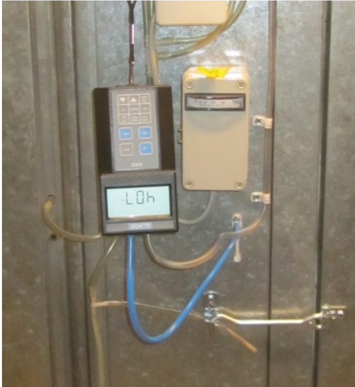
Kuva 9. Paine-eron mittausta Alnorin mikromanometrillä.
