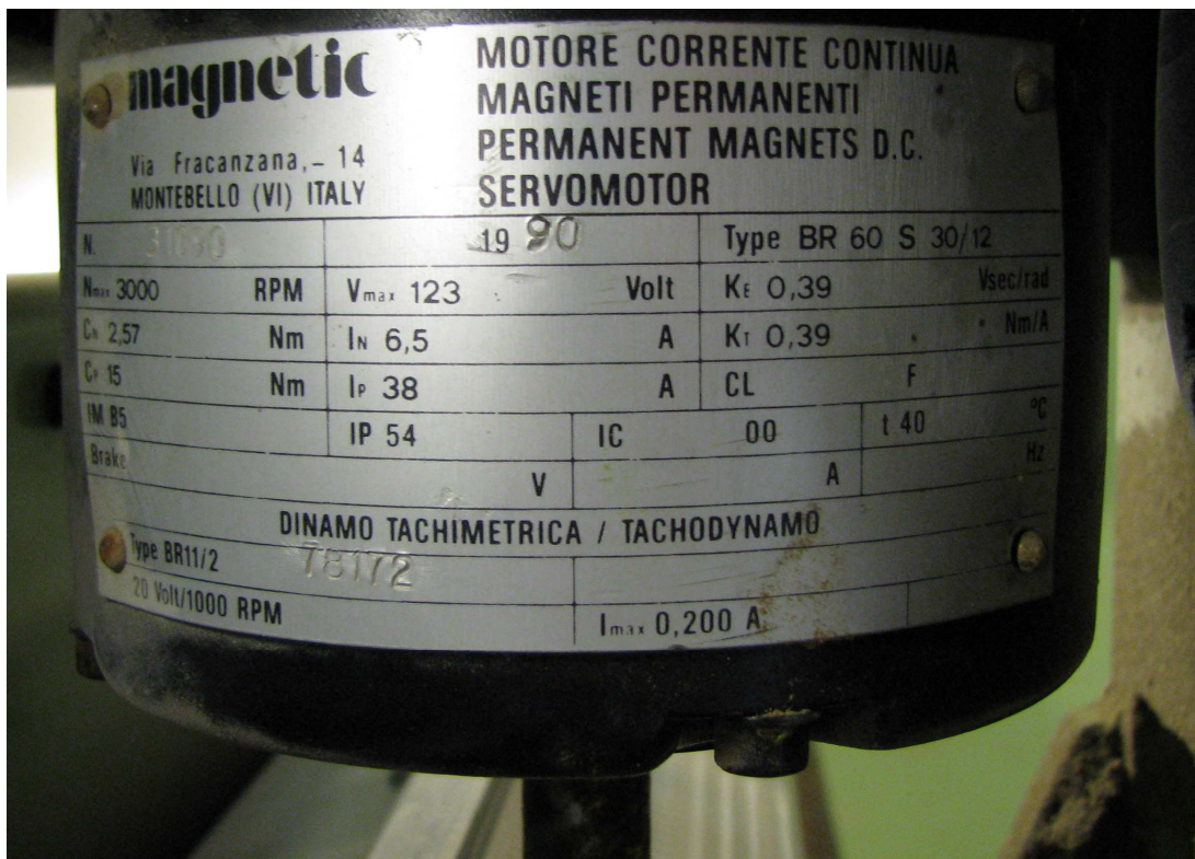
Kuva 3. Servomootorin yhteydessä oleva takogeneraattori.
