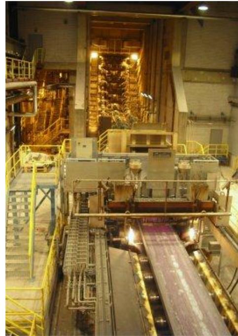
Kuva 5. Jatkuvavalukoneen kokilli. /7/ Kuva 6. Valukaari ja polttoleikkauskone. /7/
