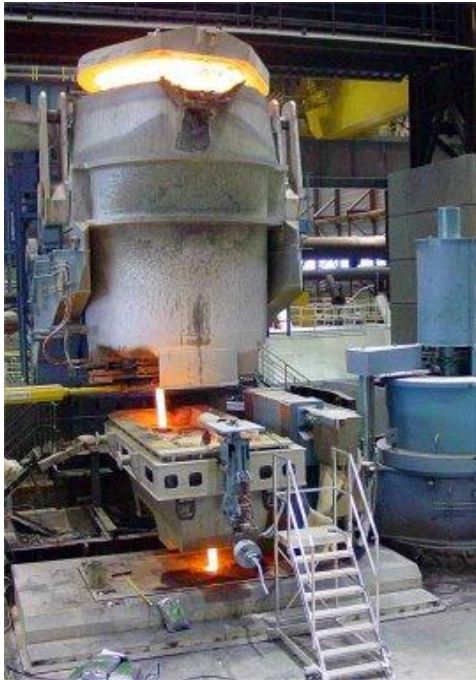
Kuva 5. Jatkuvavalukoneen kokilli. /7/ Kuva 6. Valukaari ja polttoleikkauskone. /7/
