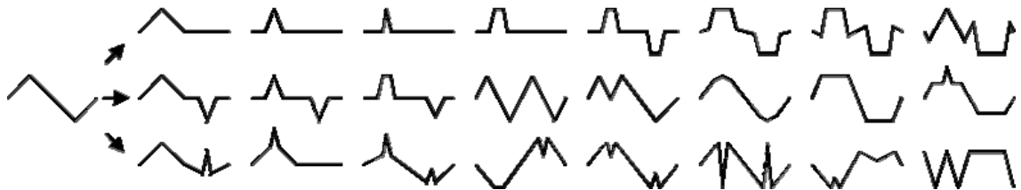
KUVA 3. Doepfer A-136 Distortion/ Waveshaper muuntaa ääniaaltojen harmonista sisältöä (Doepfer 2012).
