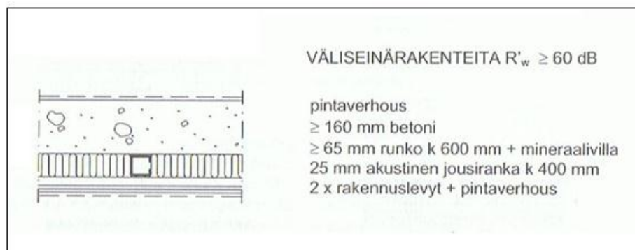
KUVA 15. Mitatun jousirankaisen väliseinän ääneneristävyys (RIL 129, 2003, 29.)
