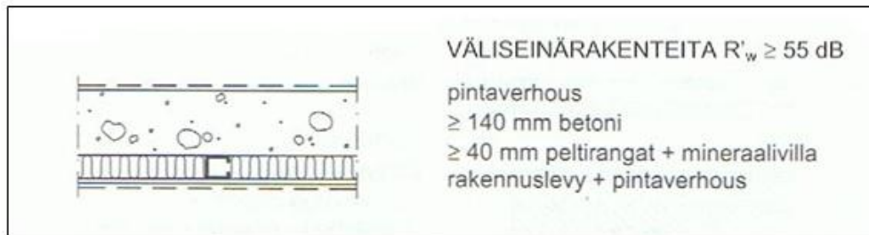
KUVA 10. Yhdistetyn väliseinärakenteen ääneneristävyys (RIL 129, 2003, 20)
