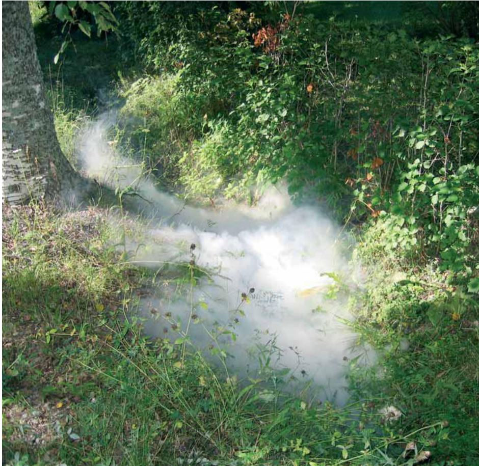
KUVA 15. Savukoe ilmaisee vuotavan viemärin. (Forsberg, M., Riihinen, H.)
