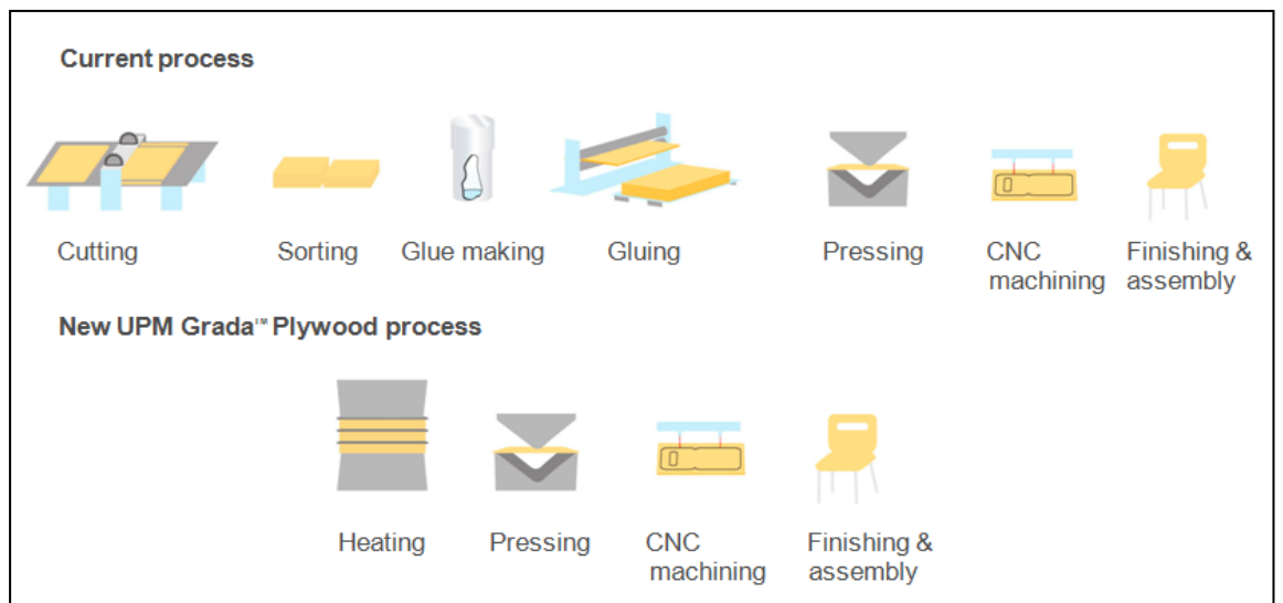
KUVIO 8. Perinteinen muotopuristusprosessi ja UPM Grada-vanerin muotopuristusprosessi. (UPM Oy 2011b).
