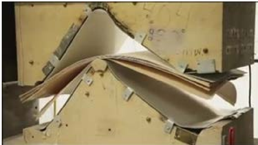
KUVIO 2. Liimoitetut viilut ladotaan muotopuristusmuottiin (UPM Oy 2011a.)
