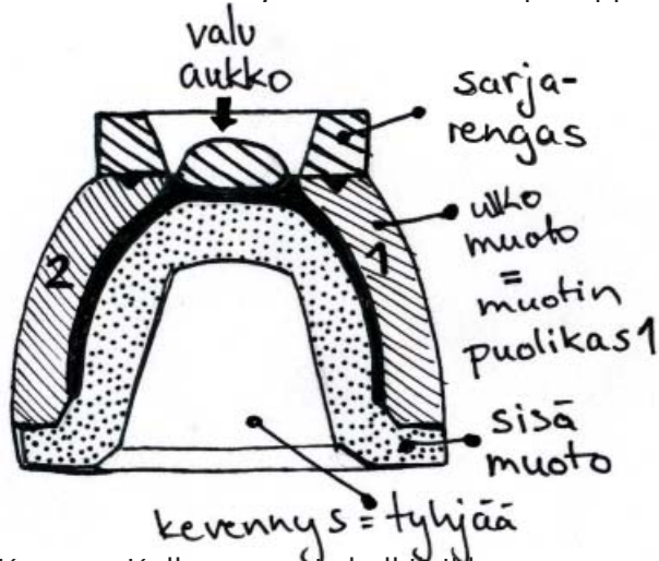
Kuva 39: Kulhon muotin halkileikkaus
