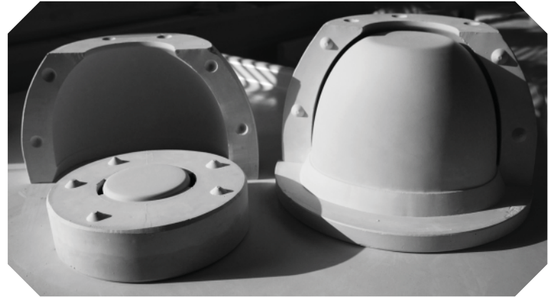
Kuva 42: Valmis kulhomuotti avattuna, edessä vasemmalla sarjarengas nurinpäin, takana muottipuoliskot, oikeanpuoleinen muottipuolisko sisämuodon päällä
