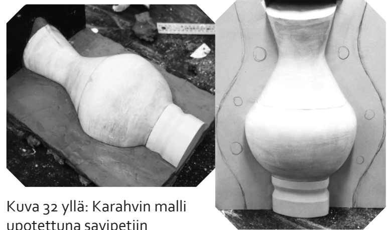
Kuva 33 vasemmalla: Karahvimalli ja pohjakappale ensimmäisen muottipuoliskon sisällä
