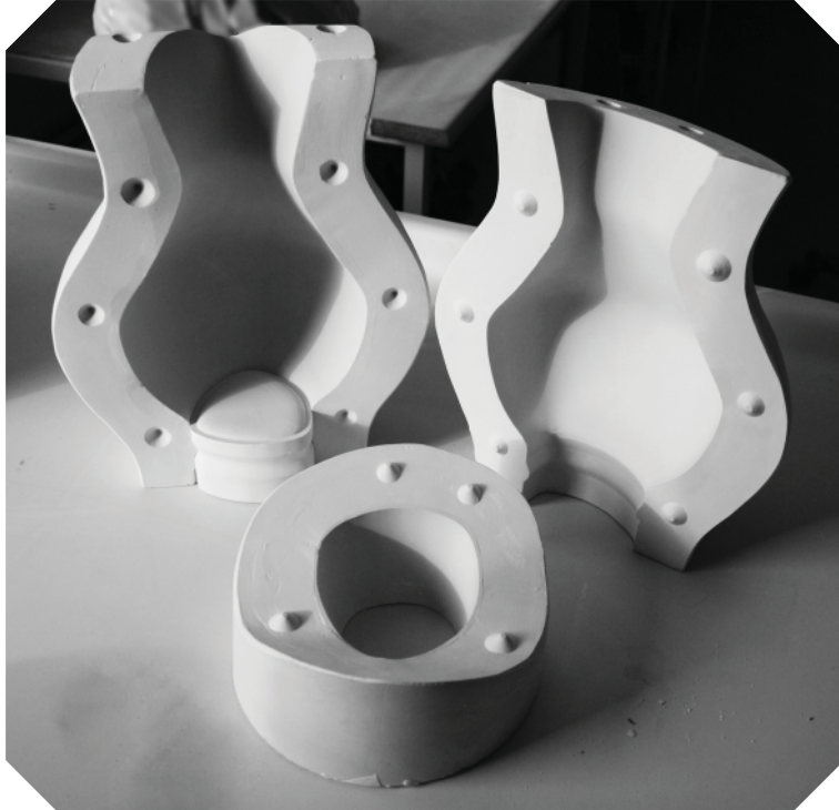
Kuva 34: Karahvin muotti: edessä sarjarengas nurinpäin, takana muottipuoliskot, vasemmanpuoleisen puoliskon alareunassa kiinni muotin pohjakappale
