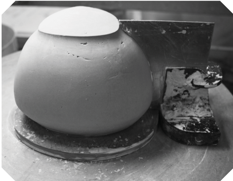
Kuva 22: Karahvin pohjakappale ylösalaisin apulevyn päällä, kuvassa näkyy myös muotopelti ja kelkka.
