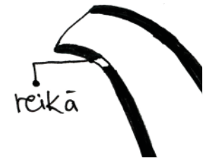
Kuva 14: Reiällinen nokka teepannussa, poikileikkaus
