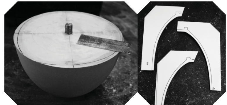
Kuva 35: Kulhon sisämuoto työstökohdat merkittynä Kuva 36: Pahviprofileja työstämistä varten
