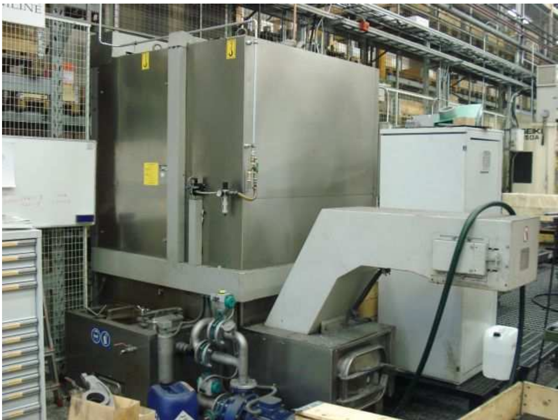
Kuva 14. Työstökoneiden lisäksi järjestelmään on kytketty Aqua Clean 1.3 palettipesuri.
